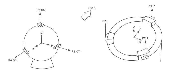
(b) CONTROL ACCELEROMETERS FOR Z AXIS
